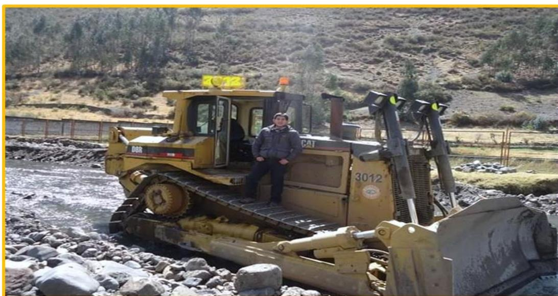
Figura 6. Máquina BULLDOZER D8R CATERPILLAR
